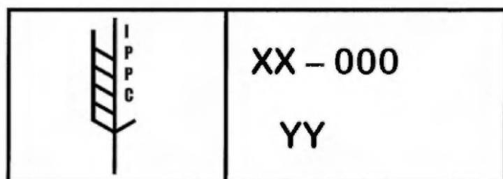
Inciso e) La marca debe tener forma rectangular o cuadrada y estar contenida dentro de un borde con una línea vertical que separe el símbolo de la IPPC, el cual debe ir en la parte izquierda, de los elementos del código.
