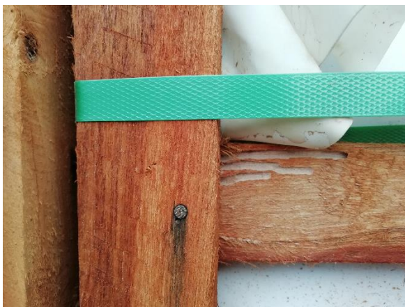
Abb. 4 und 5: Bohrgänge und Bohrmehl von Heterobostrychus pileatus . Fotos: Sibylle Eisenberger, Regierungspräsidium Tübingen
