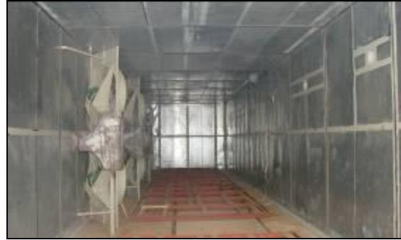
Figura 11. Cámaras de tratamiento térmico exterior e interior
