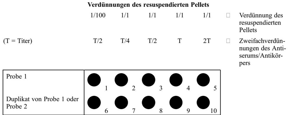
Abb. 2. Vorbereitung des Objektträgers nach 5.1 Ziffer ii und 5.3 Ziffer ii
